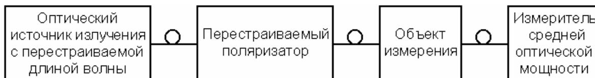
Рис. 18. Схема измерения поляризационно-зависимых потерь
